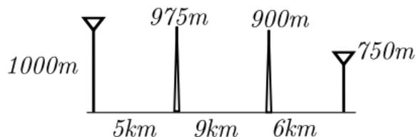
La frecuencia de transmisión es de 900MHz. Cálculo de  $h_{eq}$ :
