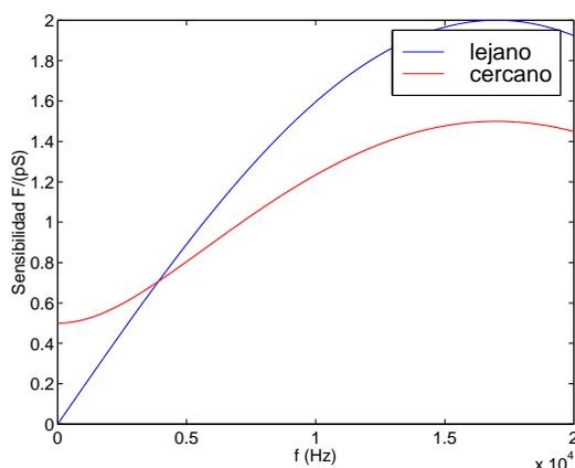
Figura 5.6: Sensibilidad del microfono de gradiente de presión para una onda plana. Dibujamos la sensibilidad aproximada así como la exacta. En baja frecuencia la sensibilidad de un microfono en campo lejano es muy baja, hay que acercarlo lo mas posible de la fuente. Para una batería se colocan los microfones dentro del bombo y para los platillos se aleja el microfono de un metro.
