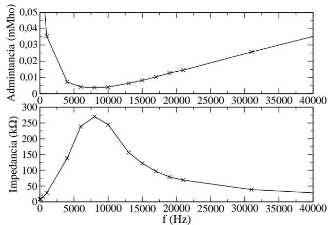
Figura 5.15: Medida de la impedancia de un microfono de guitarra de type "Humbucker", de marca Jackson. Es un microfono doble con dos bobinas en vez de una para reducir el ruido de fondo. Se observa el comportamiento inductivo en baja frecuencia y capacitivo en alta frecuencia. La impedancia en vacio (a 0Hz) es de  $8292\Omega$ .
