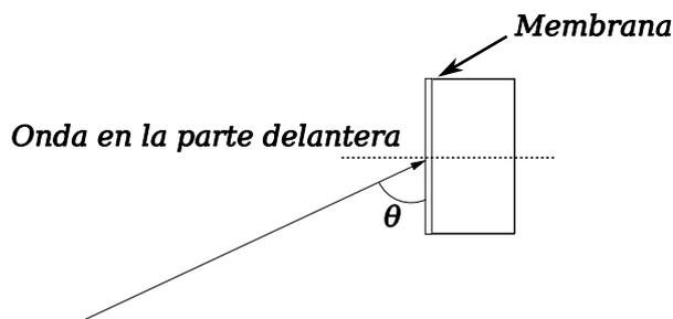
Figura 5.1: Principio del micrófono de presión, consiste en una membrana que recibe la onda directa en la parte delantera. Estos micrófonos son en general omnidireccionales hasta longitudes de ondas del orden del radio de la membrana.
