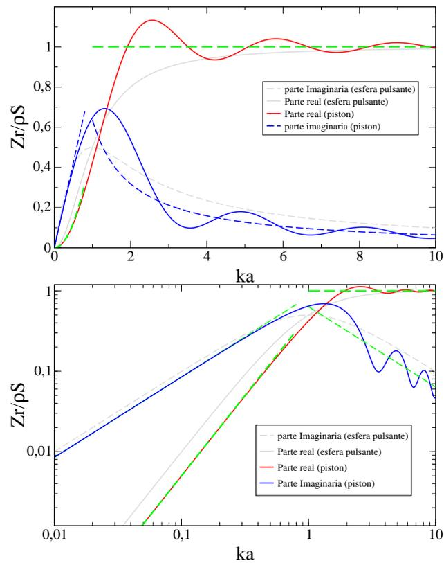
Figura 1.14: Impedancia de radiación del pistón apantallado junto con las aproximaciones en baja frecuencia y en alta frecuencia (líneas discontinuadas). En la misma figura hemos dibujado la impedancia de radiación de la esfera pulsante. Abajo representamos la misma figura en escala log-log.
