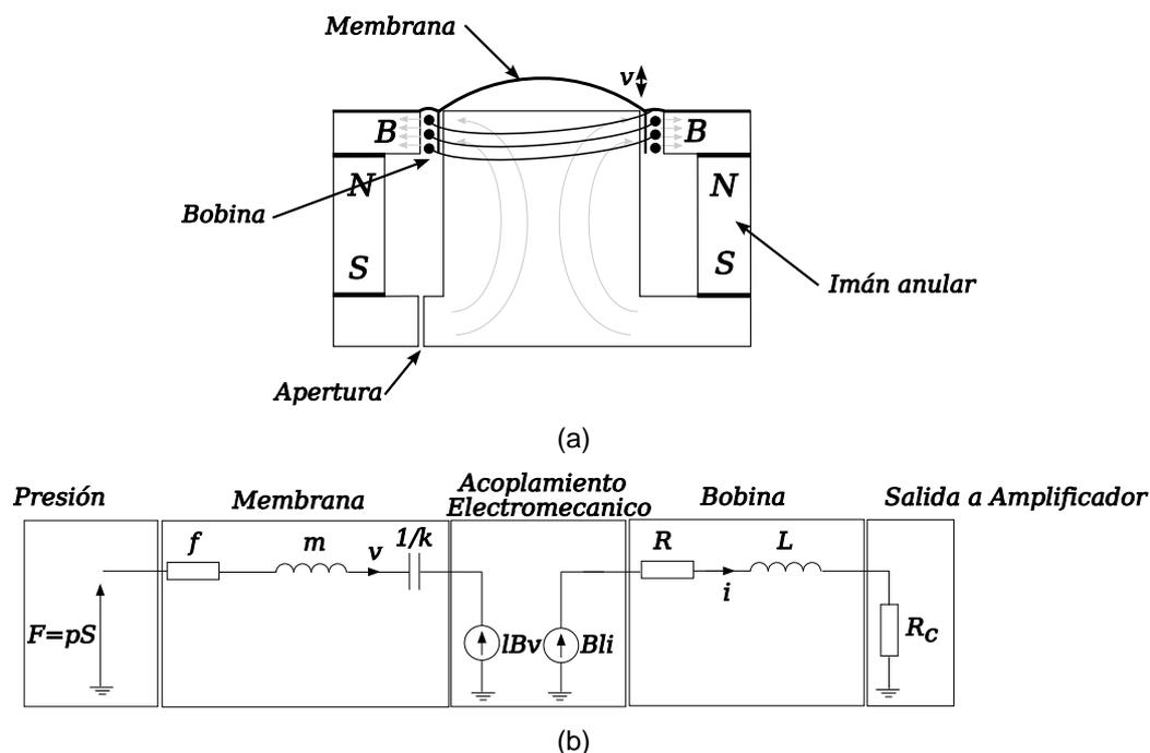
Figura 5.9: Micrófono electrodinámico
