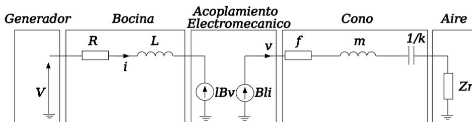
Figura 4.4: Esquema electro-mecánico equivalente completo del altavoz. La bocina se modeliza con una resistencia en serie con una inductancia. El sistema mecánico se compone de la masa del cono  $m$ , los rozamientos  $f$  así como la constante elástica  $k$  de los soportes. El acoplamiento electromecánico se puede representar también por un transformador de corriente a velocidad de relación de transformación  $Bl$
