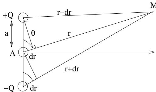
Figura 1.10: Esquema de una fuente cardioide.
