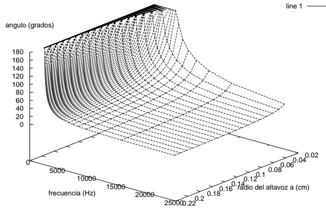
Figura 4.10: Angulo de apertura en grados de un altavoz de 10cm en función de la frecuencia. La apertura disminuye hasta algunos grados para 20Khz.
