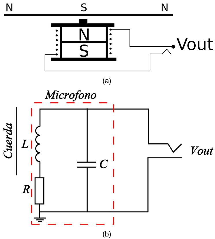
Figura 5.13: Microfonos de guitarra y esquema electrico equivalente.
