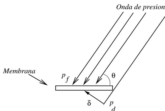
Figura 5.3: Onda de presión llegando sobre la membrana del micrófono con un ángulo  $\theta$ .
