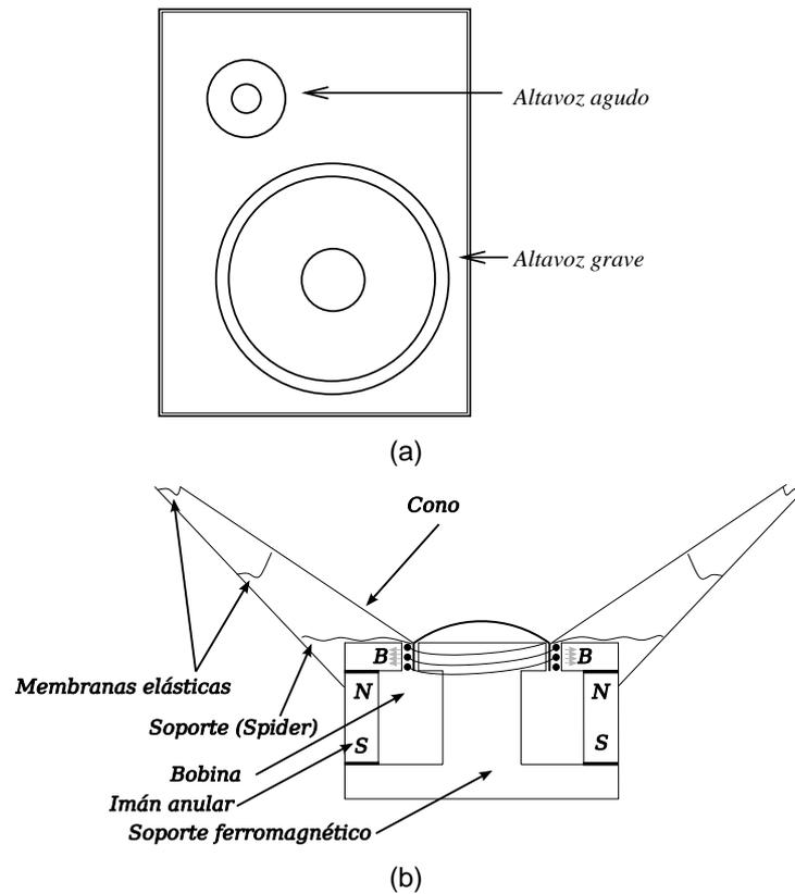
Figura 4.1: (a) Esquema de un altavoz con baffle, en general encontramos dos o tres altavoces en el mismo baffle. (b) Esquema del altavoz electrodinámico.
