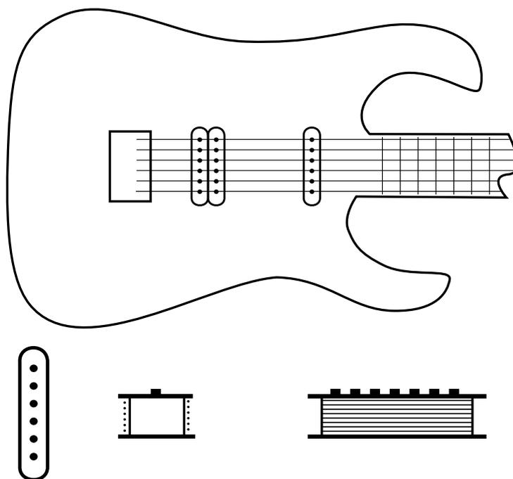
Figura 5.12: Microfonos de guitarra. Consiste en unos imanes permanente debajo de las cuerdas y alrededor tenemos un devanado de hilo de cobre.
