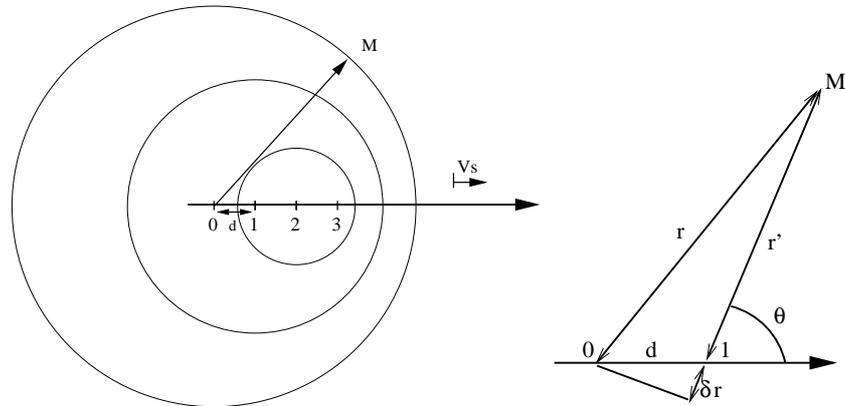
Figura 1.4: Frentes de onda generados por una fuente en movimiento y ondas percibidas por un observador situado en el punto M.
