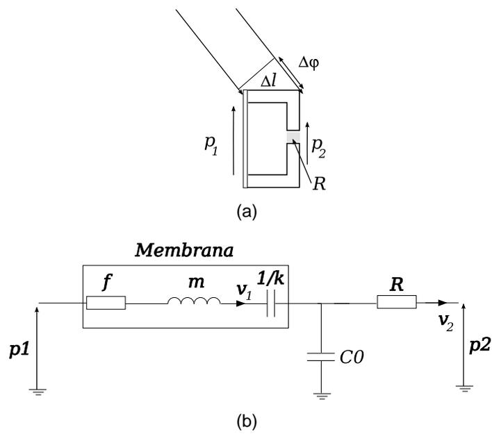
Figura 5.7: Modelo acústico de un microfono. Consiste en un pistón (equivalente de la membrana) al final de un tubo cerrado en el otro extremo.
