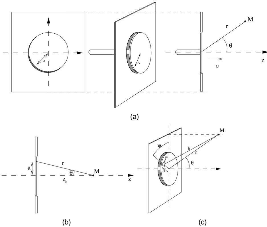
Figura 1.12: Esquema del pistón apantallado.
