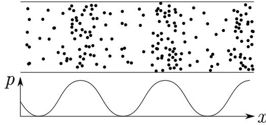
Figura 1.2: Ilustración de la propagación de una perturbación con la correspondiente presión debajo.
