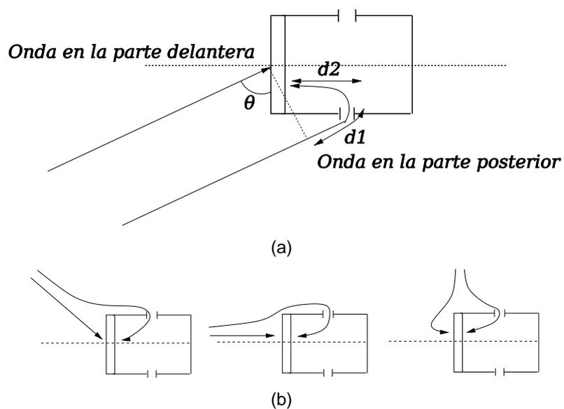
Figura 5.2: Principio del micrófono de gradiente de presión, consiste en una membrana que recibe la onda directa en la parte delantera y una onda en desfase por la parte trasera.
