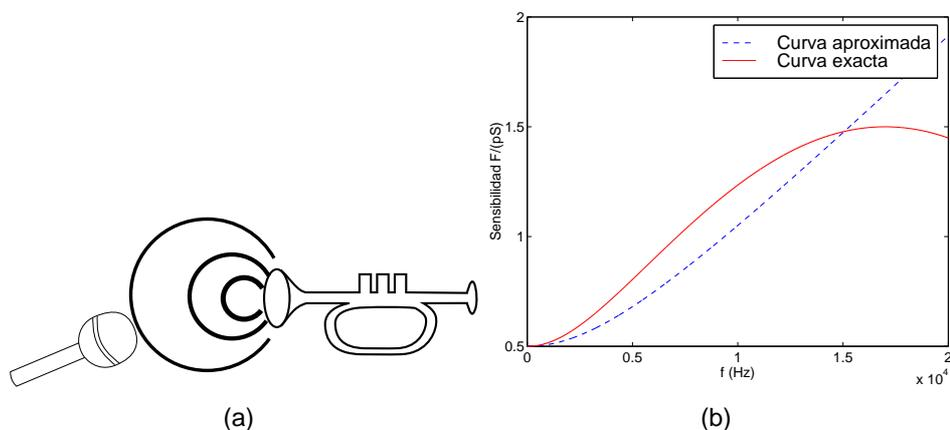
Figura 5.5: Sensibilidad del microfono de gradiente de presión para una onda esferica en campo cercano. Dibujamos la sensibilidad aproximada así como la exacta. En baja frecuencia para la sensibilidad en campo lejano el microfono es muy ineficiente hay que acercarlo lo mas posible de la fuente. Es la razón por la que por ejemplo se coloca el microfono dentro del bombo de las baterias y no fuera.
