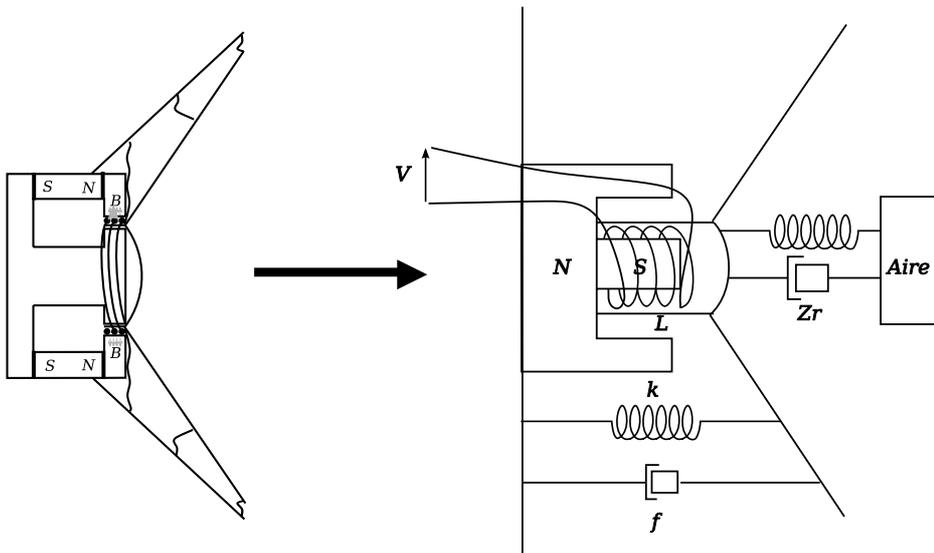
Figura 4.3: Equivalente esquemático del altavoz electrodinámico. Tenemos a la izquierda una un corte de un altavoz y a la derecha el equivalente al nivel de dinámica de cada uno de los componentes. Tenemos en la derecha los muelles corresponden a la elasticidad del baffle y el pistón los rozamientos. Tenemos además una masa de aire que el cono empuja y esta representado por una masa unida por un muelle y un pistón.
