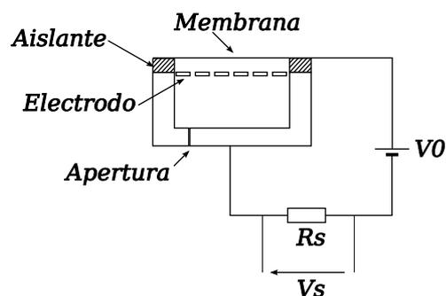
Figura 5.10: Micrófono electroestático
