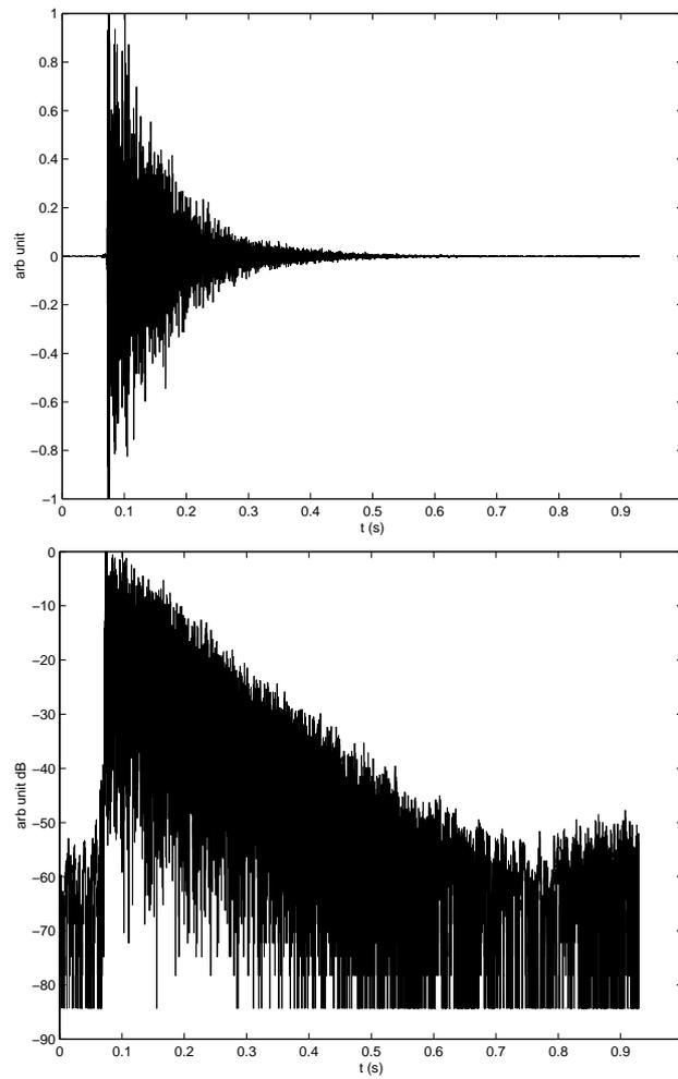
Figura 7.4: Reverberación de una sala de 8x5,4x3 m en escala lineal y en escala logaritmica.
