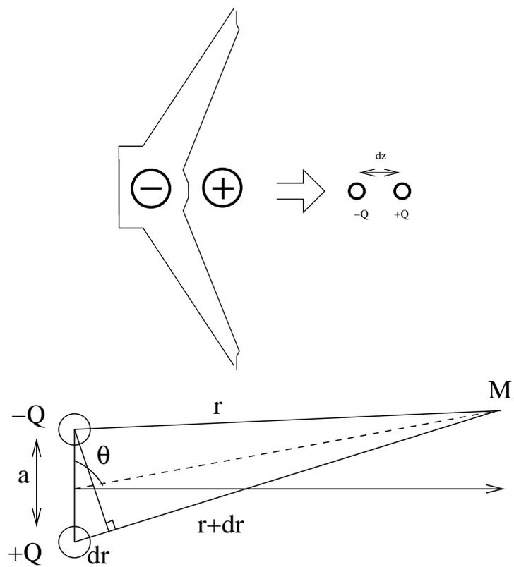
Figura 1.8: modelo del altavoz sin baffle para bajas frecuencias.
