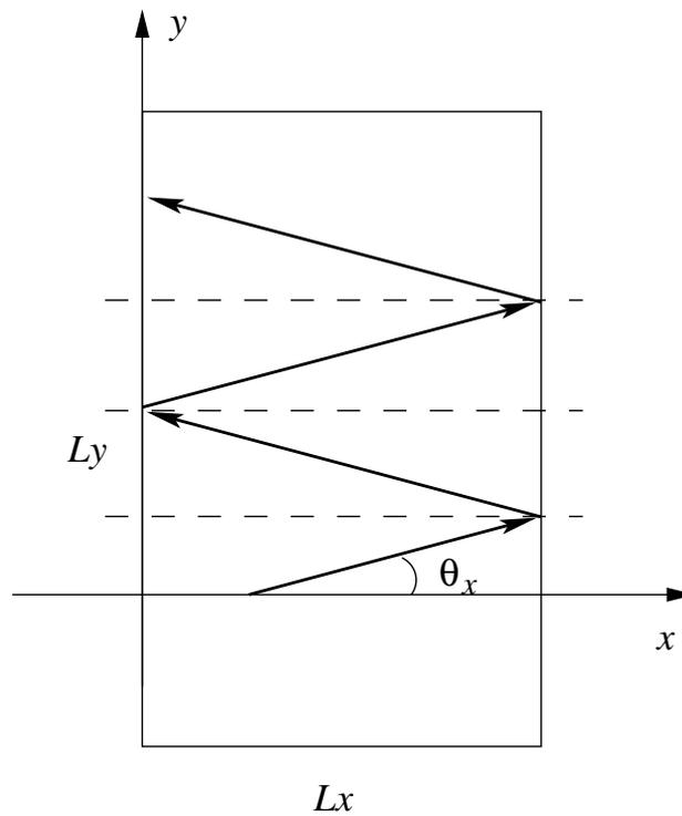
Figura 7.5: Reverberación en una sala de dimensión  $L_x, L_y, L_z$ .
