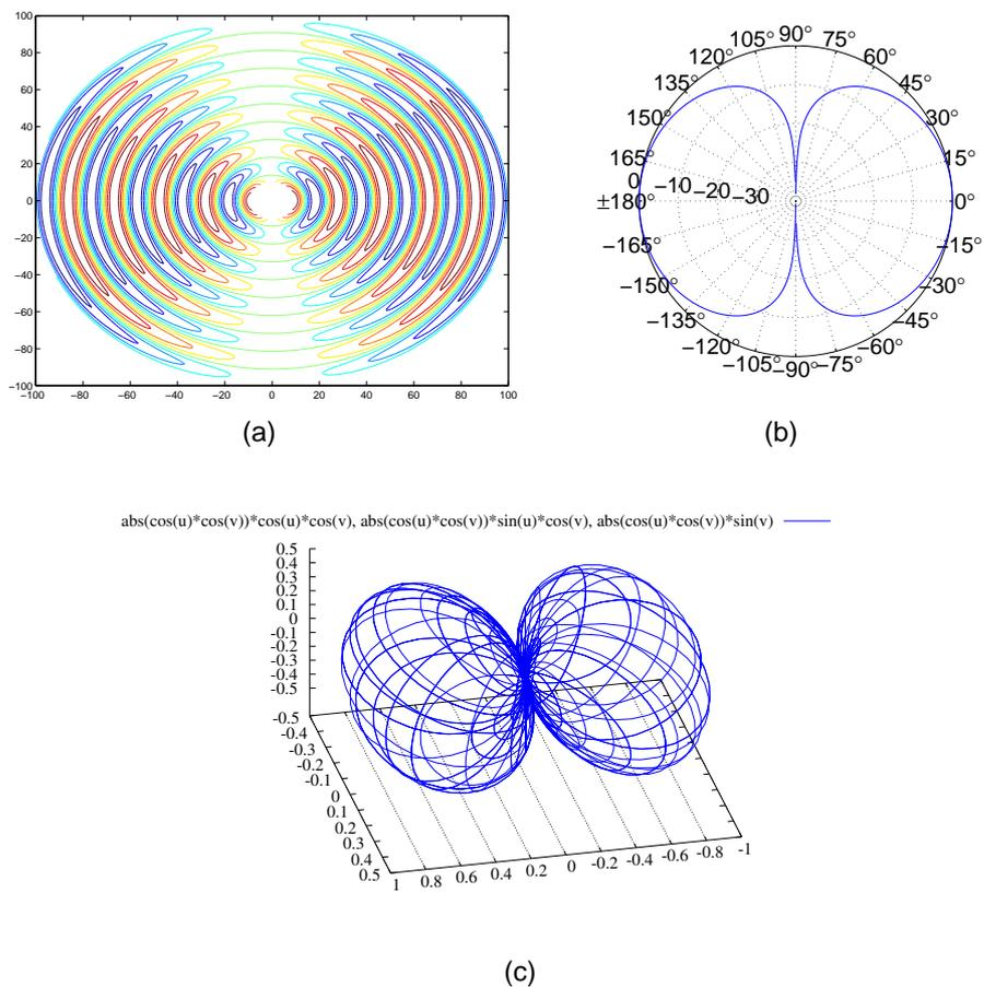
Figura 1.9: Directividad del dipolo en un plano (b) dibujado con un ejemplo de onda de presión con una directividad dipolar (a). En la figura (c) dibujamos la directividad en tres dimensiones. La directividad del dipolo es por ejemplo típica de un diapasón o de un altavoz sin apantallar.
