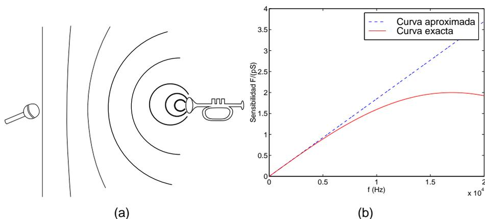
Figura 5.4: Sensibilidad del micrófono de gradiente de presión para una onda plana, ( $r = 1\text{m}$ ,  $a = 1\text{cm}$ ). Dibujamos la sensibilidad aproximada así como la exacta, según el eje del micrófono.
