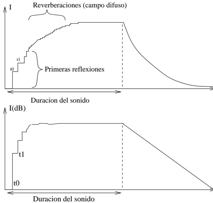
Figura 7.3: Reverberación de una sala con un sonido prolongado en intensidad y en logaritmo de la intensidad.
