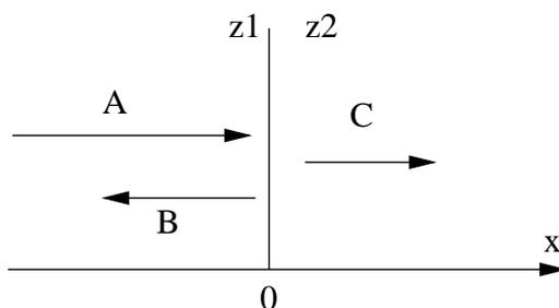
Figura 1.5: Onda reflejada y transmitida en una interfaz entre dos medio de impedancia  $z_1$  y  $z_2$ .
