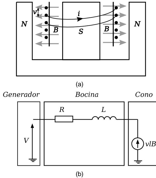
Figura 4.2: (a) Esquema de la base del altavoz, la bobina y el iman. (b) Esquema eléctrico equivalente del altavoz.
