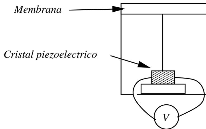
Figura 5.11: Principio del micrófono piezoeléctrico
