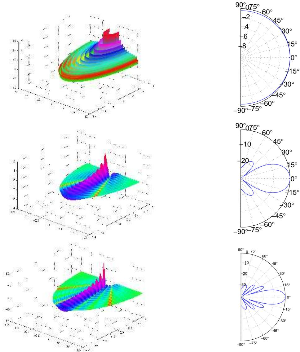
Figura 1.13: Diagrama de directividad en dB para  $A = 0,1\text{m}$  y tres longitudes de ondas:  $\lambda = 1\text{m}$  (arriba),  $\lambda = 0,1\text{m}$  y  $\lambda = 0,05\text{m}$  (abajo). Las figuras en tres dimensiones proporcionan la presión del pistón en tres dimensiones para  $r \in [0,5; 2]\text{m}$ , la presión tiene una dependencia de la amplitud en  $1/r$ .
