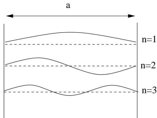
Figura 7.1: Modos de una onda en una cavidad de longitud  $a$  con la condición de contorno  $\frac{\partial p}{\partial r} = 0$  en las paredes. Solo presentamos los tres primeros modos de vibración.
