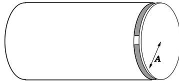
Figura 5.8: Modelo acústico de un microfono. Consiste en un pistón (equivalente de la membrana) al final de un tubo cerrado en el otro extremo.
