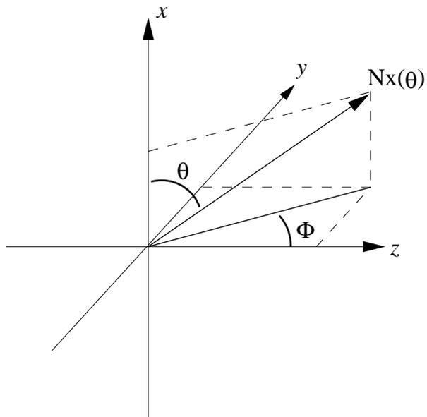
Figura 7.6: Para poder tener la cantidad media de reflexiones por unidades de tiempo integramos la densidad  $n_x(\theta)$  sobre todos los ángulos posible de propagación es decir para  $\theta \in [0; \pi]$  y  $\Phi \in [0; 2\pi]$ .
