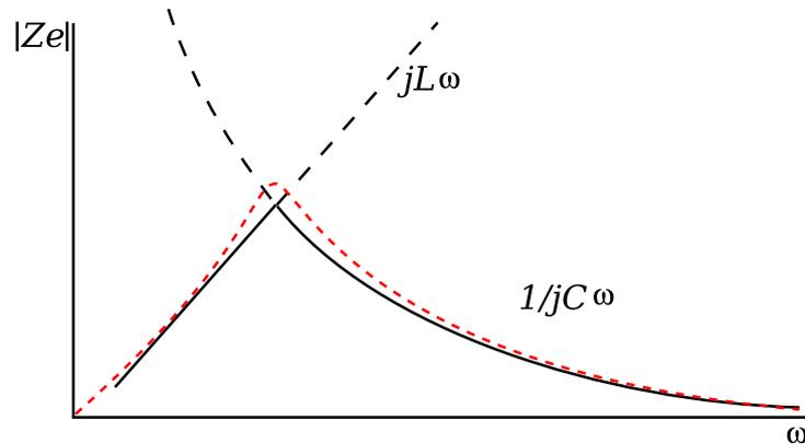
Figura 5.14: Representación del módulo de la impedancia del microfono en función de la frecuencia.
