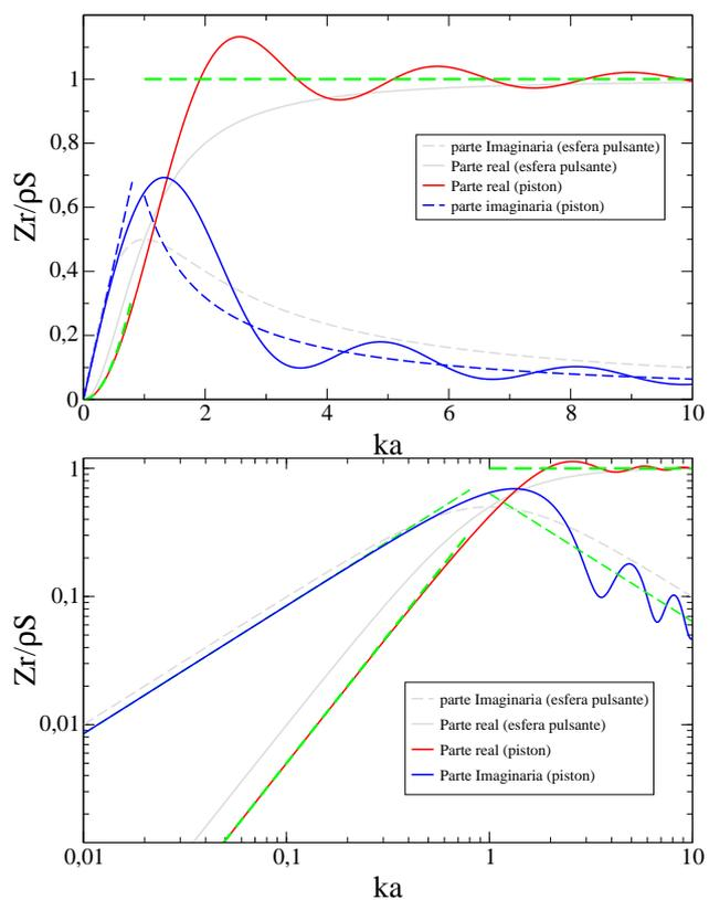
Figura 4.5: Impedancia de radiación del pistón apantallado junto con las aproximaciones en baja frecuencia y en alta frecuencia (líneas discontinuadas). En la misma figura hemos dibujado la impedancia de radiación de la esfera pulsante. Abajo representamos la misma figura en escala log-log.
